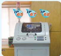
防水水壓測試機 (水深可達700米)
